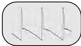
⑨ 58.0 Vp-p IC451 PIN 5 (V OUT)
